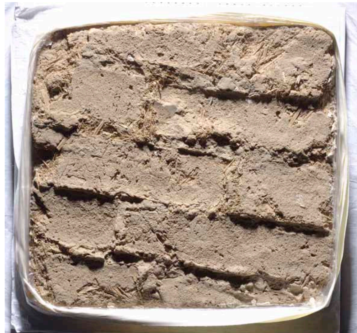
Afb. 8 De achterzijde met een patroon van stenen en voegen, de breuk loopt als een kronkelige lijn van links naar rechts
